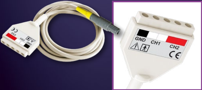
41-0068 EMG-Ableitkabel 2-Kanal, für AVALANCHE® Headbox, zum Anschluss von farbig kodierten Einmal-Nadelelektroden mit Steckern nach DIN 42802-1 (weiß, rot), Kabellänge 1,5 m, geschirmt, Stecker gelb/grau, nicht autoklavierbar
