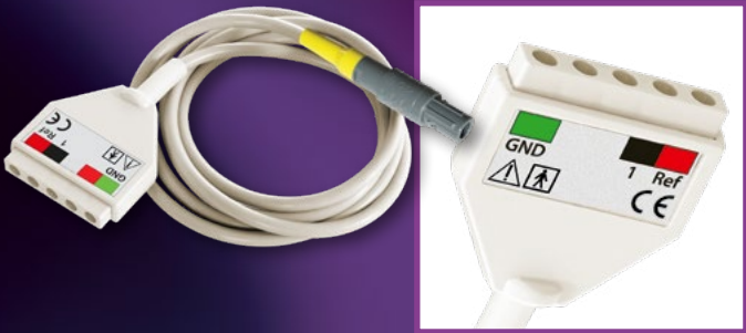
41-0018 EP-Ableitkabel 1-Kanal, aktiv, für AVALANCHE® Headbox, zum Anschluss von Elektroden mit Steckern nach DIN 42802-1, Kabellänge 1,5 m, geschirmt, Stecker gelb/grau, nicht autoklavierbar
