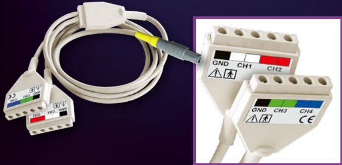
41-0069 EMG-Ableitkabel 4-Kanal, Kabelbezeichnung 1-4, für AVALANCHE® Headbox, zum Anschluss von farbig kodierten Einmal-Nadelelektroden mit Steckern nach DIN 42802-1 (weiß, rot, grün, hellblau), Kabellänge 1,5 m, geschirmt, Stecker gelb/grau, nicht autoklavierbar
