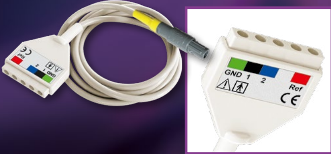
41-0019 EP-Ableitkabel 2-Kanal, aktiv, für AVALANCHE® Headbox, zum Anschluss von Elektroden mit Steckern nach DIN 42802-1, Kabellänge 1,5 m, geschirmt, Stecker gelb/grau, nicht autoklavierbar
