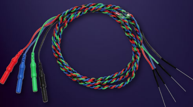
42-9721 Subdermaler Einmal-Nadelelektroden-Zopf 2-Kanal referenziell, bestehend aus 4 Elektroden (twisted wire), rot, grün, schwarz, blau, Nadellänge 18 mm, Nadeldurchmesser 0,4 mm, Kabellänge 1 m, 20-25 cm freies Ende, mit Steckern nach DIN 42802-1, einzeln steril verpackt, PE = 10 Stück
