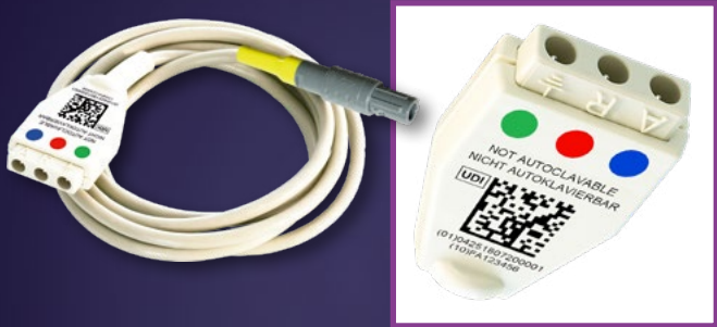
41-0010 EMG-Ableitkabel 1-Kanal, für AVALANCHE® Headbox, zum Anschluss von Elektroden mit Steckern nach DIN 42802-1, Kabellänge 1,5 m, geschirmt, Stecker gelb/grau, nicht autoklavierbar
